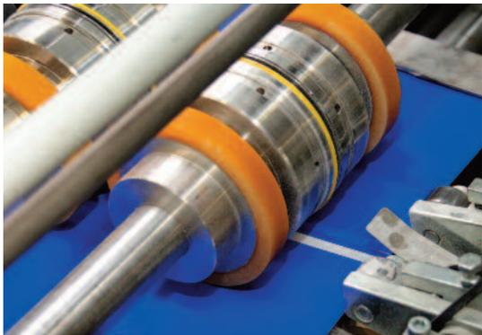
*In das völlig neu entwickelte Technifold-Rillwerkzeug für den Kolbus-Hochleistungs-Klebebinder wurde ein Präzisions-Kugellager integriert.*
